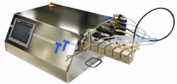
ZE 12 mit 5 Heizzonen, separate Wasser/Luft Kühlung, Druck- und Temperatursensor an der Düse, Siemens Steuerung
