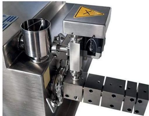
Stopfdosiergeräte werden für die zuverlässige Zuführung von sehr schlecht dosierbaren bzw. sehr kohäsiven und sehr leichten Produkten in einen Extruder verwendet. Mit dem Stopfdosiergerät werden Produkte von oben in das Barrel des Extruders gedrückt. Damit kann die Produktqualität verbessert sowie die Dosierkonstanz und der Durchsatz des Extruders erhöht werden. Dank Schnellspannclamps kann das Stopfdosiergerät einfach und schnell demontiert und gereinigt werden.
