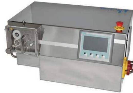
Mit dem Granulator lassen sich Stränge zu Granulat verarbeiten. Die Geschwindigkeit der Einzugsrolle und des Schneidmessers sind unabhängig voneinander einstellbar. Dadurch kann der Extrudateinzug perfekt auf das Extrudat abgestimmt und die Granulatgrösse während dem Verarbeitungsprozess zwischen 0.5 bis 10 mm eingestellt werden.
