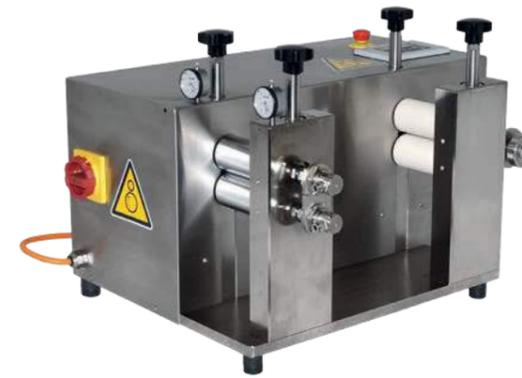
Die Folienwalze ermöglicht das Kalibrieren von flachen Extrudaten. Ausserdem können runde Extrudate zu einer Folie mit definierter Dicke ausgewalzt und anschliessend gleichmässig auf eine Spule aufgewickelt werden. Die Folienwalze besteht aus einem einstellbaren und temperierbaren Walzenpaar, einem einstellbaren Zugrollenpaar und einem Aufwickler bzw. einer Spule.
