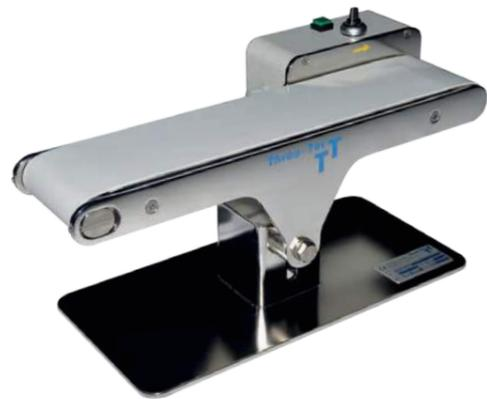
Das Förderband eignet sich für den schonenden Abtransport und das Abkühlen des Extrudates. Um eine effizientere Abkühlung des Extrudates zu erreichen, kann optional ein Kühl-tank, auf dem das Band aufliegt und fortlaufend abgekühlt wird oder eine Luftkühlung integriert werden. Dies ermöglicht das Abziehen von Extrudaten mit einer Temperatur von bis zu 300 °C.
