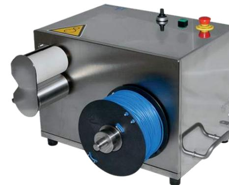
Der Aufwickler eignet sich für das Aufwickeln des Extrudates auf eine Spule. Die Zugkraft zwischen der Abzugsrolle und der Spule ist einstellbar, was ein sehr gleichmässiges Wickeln ermöglicht. Nebst runden Strängen lassen sich mit dem Aufwickler auch bandförmige Extrudate auf eine Spule aufwickeln. Angesteuert wird der Aufwickler mittels integriertem Potentiometer.
