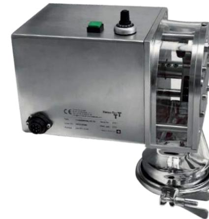
Mit dem Heissabschlag lässt sich das Extrudat mit einem oder mehreren direkt an der Düsenplatte anliegenden Messern zuverlässig in Granulate verarbeiten. Es können sowohl Feucht- als auch Schmelzextrudate verarbeitet werden. Die Anzahl der eingesetzten Messer sowie die Einstellung der Drehzahl ermöglichen die Herstellung von Granulatgrössen zwischen 0.5 bis 5 mm.
