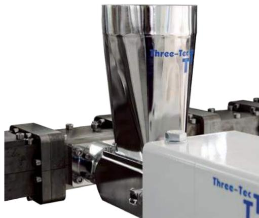
Seitendosiergeräte werden für die Zwangszuführung von Pulvern, Granulaten oder Fasern in einen Extruder verwendet. Damit kann die Produktqualität verbessert und der Durchsatz des Extruders erhöht sowie Additive schonend verarbeitet werden. Dank Schnellspannclamps kann das Seitendosiergerät einfach und schnell demontiert und gereinigt werden. Three-Tec stellt Seitendosierer für sämtliche Extrudergrößen und Durchsatzbereiche her.
