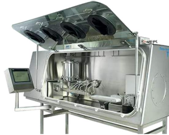
renden Teile der in den Isolator integrierten Maschinen sind aus Edelstahl 1.4404 (AISI 316L) mit einer Oberflächenrauheit von  $Ra \leq 0.8 \mu m$  gefertigt.
