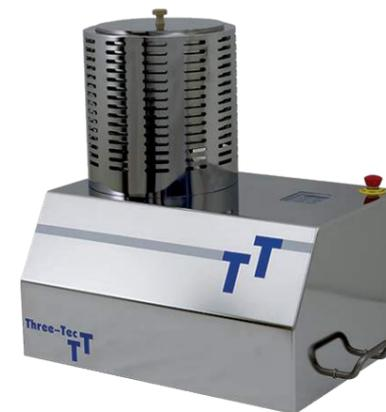
Der Spheronizer wird für das Reduzieren der Länge und das Abrunden von feinen Extrudatsträngen eingesetzt. Die gewünschte Geometrie des Endproduktes wird durch die Chargengrösse, die Drehzahl und die Oberflächenstruktur der Reibscheibe beeinflusst. Je nach Behältergrösse kann eine Batchmenge von 5 bis 2'000 Gramm verarbeitet werden.
