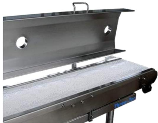
Mit dem Kühlförderband können Extrudate und Granulate effizient abgekühlt und schonend abtransportiert werden. Das Förderband liegt auf aktiv gekühlten Kühlelementen und wird während dem Betrieb permanent abgekühlt. Luftanschlüsse im Deckel des Kühlförderbandes ermöglichen eine zusätzliche Luftkühlung des Produktes.
