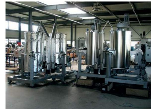
Batterieproduktion Dosiergeräte komplett isoliert
