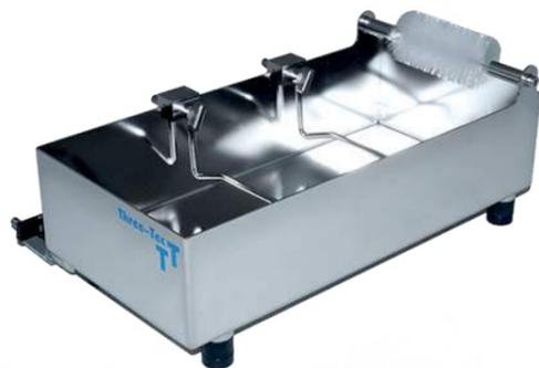
Das Kühlbad in unterschiedlichen Längen und Ausführungen dient zur effizienten Abkühlung verschiedener Extrudate vor der Weiterverarbeitung mit einem Aufwickler oder Granulator. Es ist mit Niederhaltebügeln oder Niederhalterollen und Abstreifbürste ausgestattet und auf Dämpfungselementen montiert. Über ein Ventil kann das Wasser abgelassen werden. Bei grösseren Kühlbädern kann ein Kühlgerät angeschlossen und der Wasserstand eingestellt werden.
